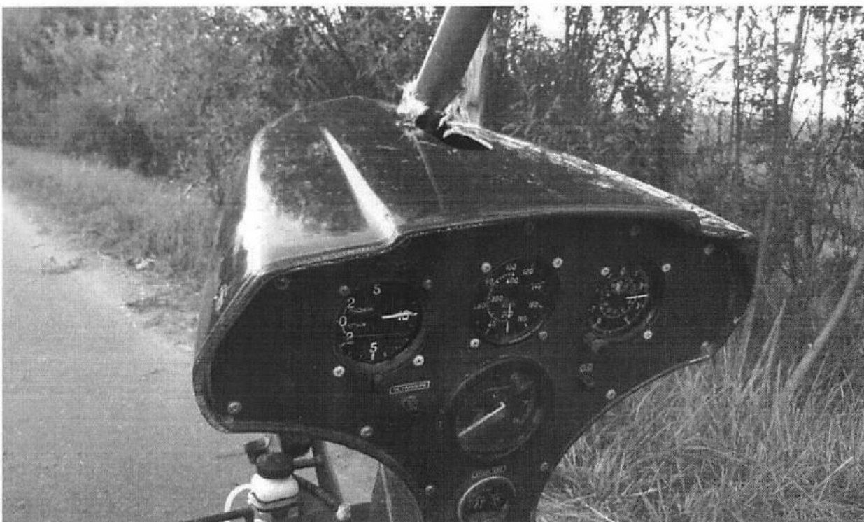
Фото 2. Повреждение обшивки обтекателя приборов
